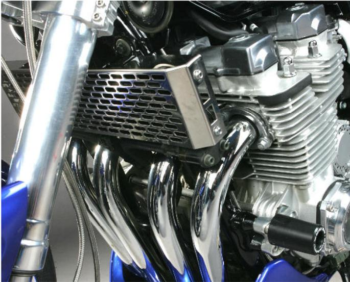
Der Kühlergrill I bietet hervorragenden Schutz vor Steinschlägen. Er deckt die komplette Frontfläche, die Seiten (rechts / links) und die Oberseite ab. Ideal auch falls der Kühler mal durch einen Sturz verbogen wurde und Beschädigungen verdeckt werden sollen. Die Serienblenden die am Kühler seitlich montiert sind entfallen
