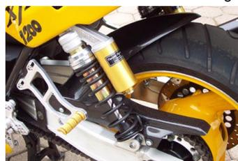
(auch in GFK). Der Vorderkotflügel hat eine geänderte Form und ist vor den Gabelholmen breiter gezogen. Die Hinterradabdeckung besitzt einen integrierten Kettenschutz.
