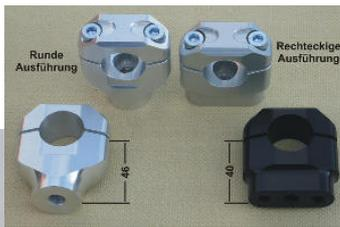
einfach auf der Seriengabelbrücke montiert werden. Sie sind lieferbar für Big-Bar Lenker mit 28,5mm Klemmung. Die Form der Unterteile kann gewählt werden zwischen Rund oder
