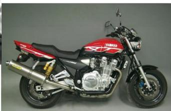
entfernt werden, bei der 4-1 Kompletanlage nicht. Die Slip-on Anlagen sind mit Alu-, Carbon- und Titan Schalldämpfern, die 4-1 Kompletanlage mit Alu-Dämpfer lieferbar. Abbildung oben 4-2 Slip-on mit ABE; Abbildung unten 4-1 Kompletanlage. Die Dämpfer haben eine romboische Form (ähnlich oval), Außenmaße 110x130mm.
