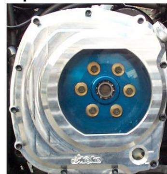
angelangt sind und die Kupplung oft rutschte bevor die Druckplatte verbaut wurde, dann sollte man die Lamellen gleich mit wechseln. Im Lieferumfang ist die Druckplatte mit sechs Einzelfedern enthalten.
