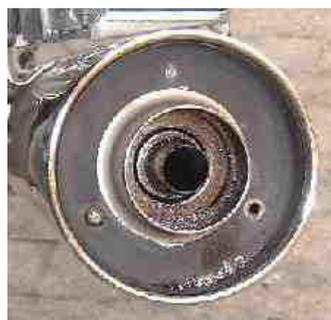
Heiß begehrt sind unsere Edelstahl Auspuffänderungen. Der Auslass der Serierendämpfer wird von innen 20mm auf 28mm vergrößert und die Umlenkung in der letzten Kammer des Dämpfers wird umgangen. Der Sound wird deutlich dumpfer und nur mäßig lauter. Das Fahrgeräusch erhöht sich um ca. 4 DB. Somit liegt es normalerweise innerhalb des Toleranzbereiches. Eine ABE
