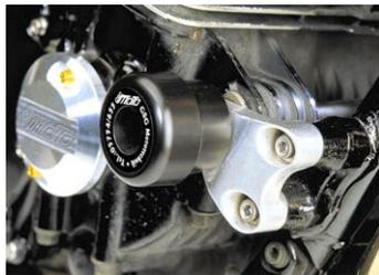
Bei unserem Lieferanten haben wir einen Hersteller ausgewählt, bei dem wir und Du auf die Qualität des Produktes vertrauen können und sichergestellt ist, dass die beste Befestigungsmöglichkeit gewählt wurde. Alle Modelle haben Kunststoffpads mit 60mm Durchmesser, des Weiteren sind sie mit einem großen Radius versehen um die Gleiteigenschaften zu verbessern.
