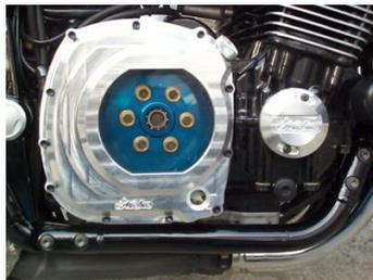
hervorstechend und daher nicht nur interessant, wenn ein Deckel wegen Sturz getauscht werden muss. Die Lösung dieses Kupplungsdeckels ist die einzig richtig funktionierende, denn die Motorentlüftung ist schlichtweg super und es wird kein Öl aus der Entlüftung gedrückt! Bei dem Deckel liegt eine ausführliche Montageanleitung bei!
