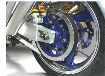
Lastwechselspiels deutlich besser einrasten. Der Zahnriemen hält auf der XJR mindestens 30.000 km, dann ist ein Riemenwechsel zu empfehlen. Er kann aber durchaus auch bis zu 40.000 km gefahren werden. Die hintere Riemenscheibe können wir im Innenring gerne für Euch lackieren und die
