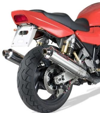
Carbon- oder Titanmantel geliefert werden. Die Trioval Dämpfer haben ein tolles eigenständiges Design. Der Vorteil bei den neuen ABE Dämpfern ist der herausnehmbare DB-Killer, bei denen man zu Rennzwecken die Lautstärke „anpassen“ kann. Das die Dämpfer damit ihre Straßenzulassung verlieren, ist wohl klar! Für die XJR ab 2004 sind auch Anlagen mit Kat
