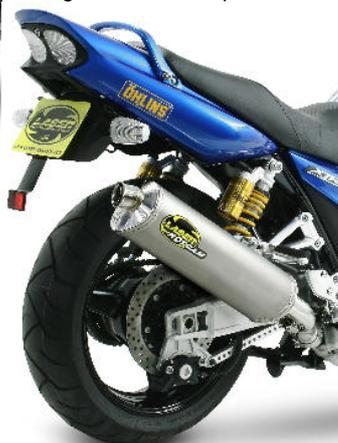
Schräglagenfreiheit da der Dämpfer nach unten hin schmaler wird und somit näher am Motorrad anliegt. Deutlich zu erkennen auf dem Detailbild. Diese Dämpfer sind mit Carbon und Titanmantel erhältlich. Vom technischen Aufbau her sind die Dämpfer dem Duo-Tech ähnlich und haben ebenfalls den ABE und den Racingeinsatz.
