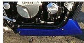
Der große Spoiler 1 zeichnet die unteren Motorconturen nach und liegt eng am Motorrad an. Die Kanten sind, wie bei allen unseren Bugspoilern, nach innen eingeschlagen; so ist keine Kante sichtbar und die Spoiler sehen edel aus.
