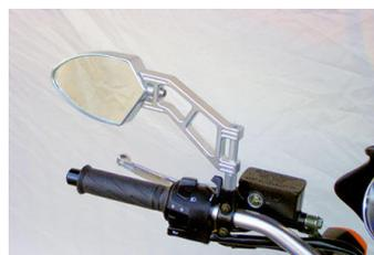
eines „Falles“ sind auch alle Teile einzeln erhältlich. Achtung: Yamaha verwendet bei rechten Spiegeln ein Linksgewinde zur Befestigung, daher sind rechte und linke Spiegel separat aufgeführt. Wem die Spiegel nicht weit genug nach außen stehen, der kann gegen Aufpreis auch Adapter mit dazu bestellen, die den Spiegel um ca. 40mm
