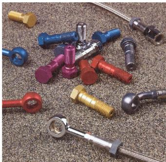
Für den Anschluss der Radialbremspumpen, oder bei Umbau auf eine andere Fußrastenanlage, ist oft die Verwendung eines hydraulischen Stopplichtscharter vorgesehen. Dieser wird einfach anstatt einer Bremsleitungshohlschraube verwendet. Es ist aber darauf zu achten, dass die Gewindesteigung übereinstimmt. Yamaha verwendet M10x1,25, viele Hersteller von Bremspumpen jedoch M10x1. Im Zweifelsfalle den Hersteller der Pumpe angeben!
