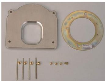
Unser günstigster Satz ist das Kit 1 (Abbildung zeigt Kit für die XJR 1200); hiermit werden ca. 8-10PS Mehrleistung erreicht. Die nächste Ausbaustufe ist das Kit 2; er besteht aus Kit 1 und zusätzlich offenen Ansaugstutzen. Mit diesem Kit lassen sich 12-15PS Mehrleistung gegenüber Serie erreichen. Hierbei ist zu beachten, dass alle Serien-XJR schon zwischen 106 und 112 PS haben und nicht wie angegeben 98 PS.
