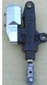
Behälter ist perfekt ausgearbeitet, denn im Gegensatz zu Billigprodukten haben diese Behälter wie die Serienteile auch eine Manschette mit Entlüftung, dies verhindert erstens das Auslaufen der Flüssigkeit und auch dass der Behälter Vakuum ziehen kann, das zum Bremsversagen führt. Um den Flüssigkeitsstand bequem zu prüfen sind Sichtfenster eingearbeitet. Die Behälter sind ich Alu natur (polierfähig), silbern oder schwarz eloxiert erhältlich.
